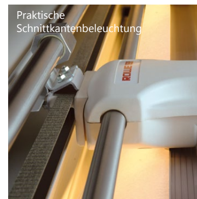
Selbstschärfender und wartungsfreier Messerkopf
